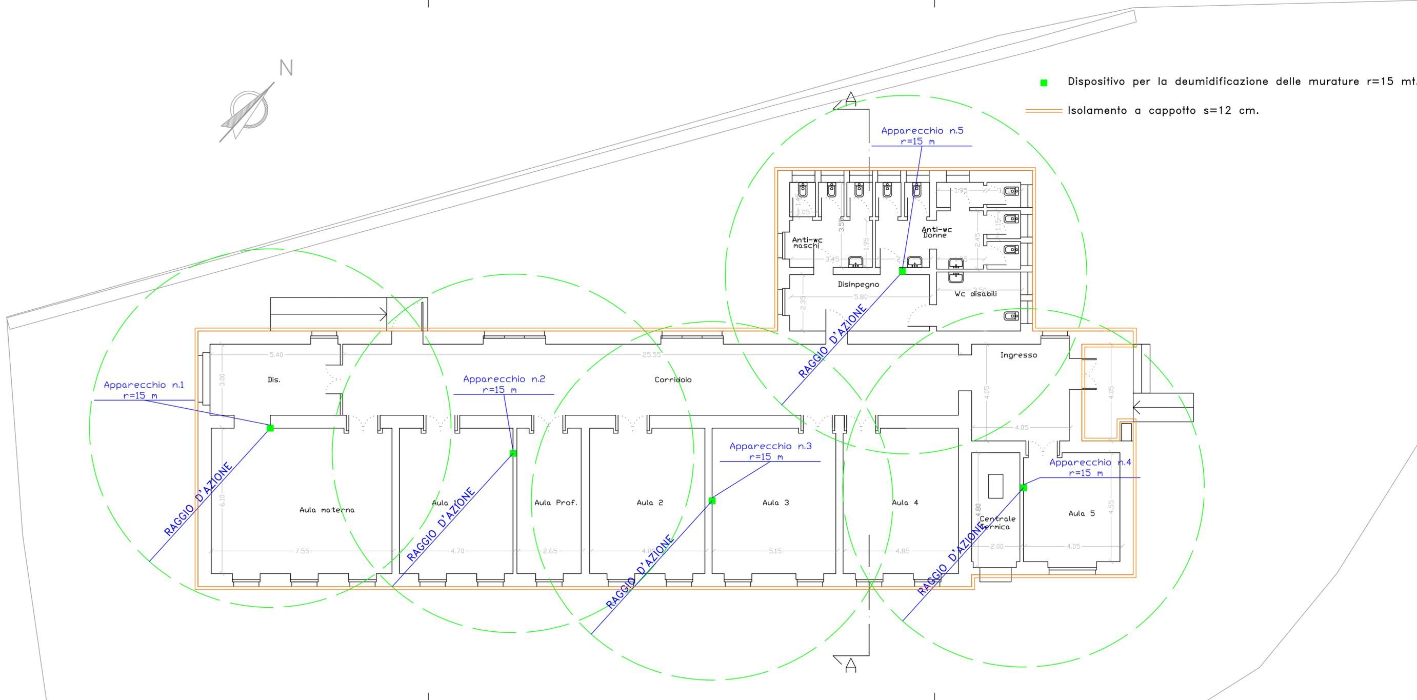
■ Dispositivo per la deumidificazione delle murature r=15 mt.
